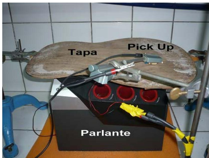
**Figura 5.** Detalle del dispositivo sobre la tapa de guitarra.
