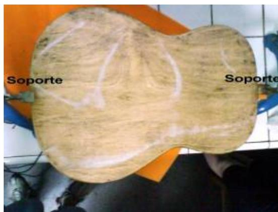
**Figura 3.** Patrón de Chladni en la tapa de guitarra soportada por los extremos.
